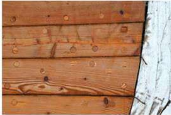
Aboutissement de bordés de coque sur l'étambot du Miguel Caldentey , premier nom du Principat de Catalunya .
