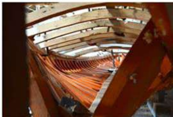
Vue de la charpente transversale de la Mary Flore , sortie en 1944 du chantier naval Raphaël Camarotta, à Sète.
